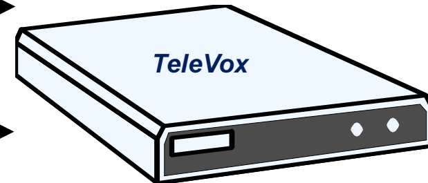
Grabador de hasta 48 canales con 2 interfaces telefónicas de 24 canales cada una.
